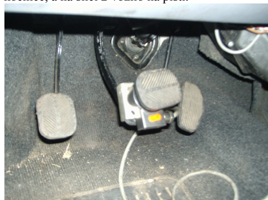
Slika 1 – Davač sile na pedali kočnice
