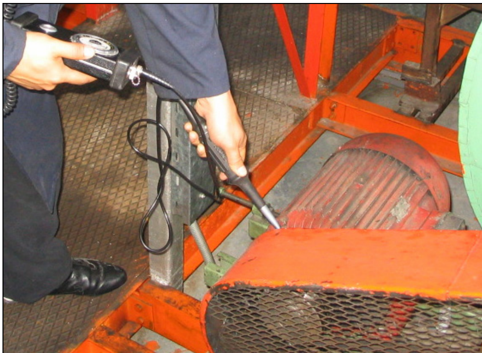
Slika 4. Dijagnostike stanja ležaja SPM metodom u pogonu
