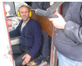
Slika 4.2 - Merenje vibracija na mestu operatera
