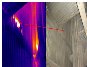
Slika 4.5 - Termografske i digitalne fotografije mesta sa potencijalnim curenjem fluida
