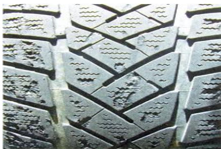
Slika 10a - Pri velikim brzinama, ubrzanjima ili kočenjima pneumatici se raspadaju [6] Dangerous Substances Directive
