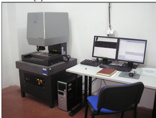
Slika 19 - Koordinatna merna mašina Weth Video Check IP250
