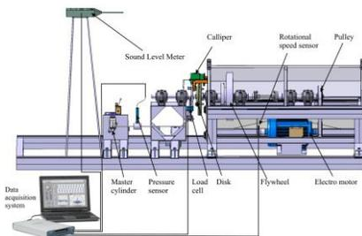
**Figure 3. Brake Noise Dynamometer[9]**
